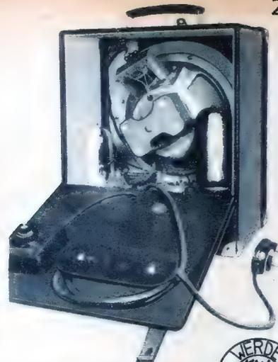
Wenn wir den rückwärtigen Deckel aufmachen, so sehen wir vieles. Auf dem Deckel selbst den Sperrkreis und die Rolle zum Aufwickeln der Litze, innerhalb des Gerätes, rechts die Röhre, links die Widerstands Lampe und den Gleichrichter, in der Mitte der Lautsprecher. (Photos: Wacker)
